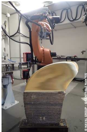
Pale d'hélice réalisée en imprimante 3D par le procédé WAAM à l'Ecole centrale de Nantes
