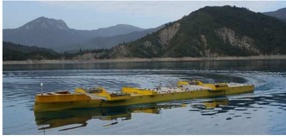
PA-Ng : Essais de performances manœuvrières (capacités de giration sous contrainte de gîte réduite)
