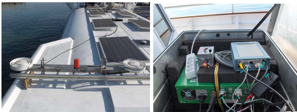
Figure 10 : Photos présentant l'implantation à bord de la chaîne d'acquisition « POS-MV » (MAURIC©)
