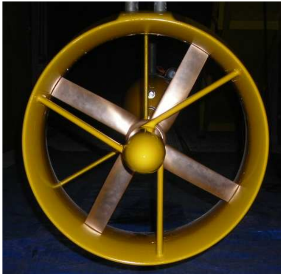
Figure 23 : Photos du rotor 4 pales monté dans la tuyère.
