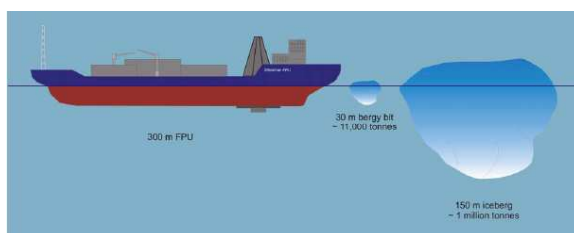
Figure 7 : Comparaison entre les tailles d'un FPU de 300 m, d'un fragment d'iceberg (11 000 t) et d'un iceberg (1 million t)
