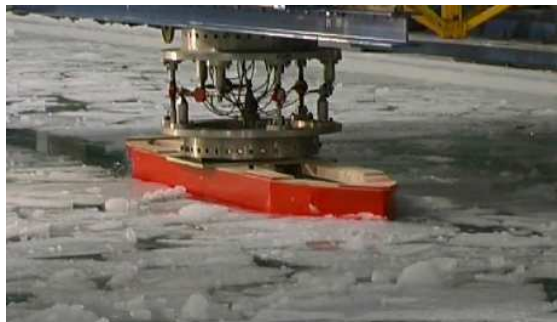
Figure 9 : Tests en bassin avec conditions de glace
