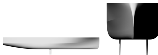
Figure 5 : Néoliner 136 m en configuration 2 plans antidérive
