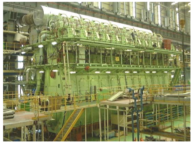
Moteur Man B&W 12K98MC-C – photo CMA CGM
