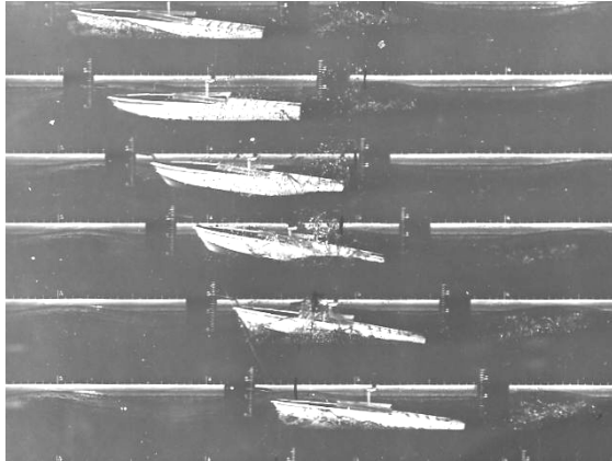
Figure 3.2: Essai d'une vedette dans la cuve de tangage en marche
