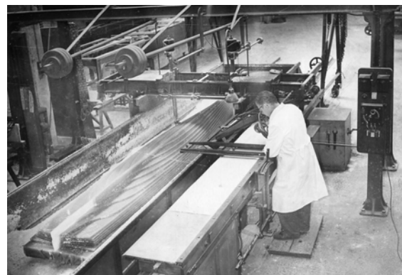
Figure 1.3: Pantographe ou machine à tailler la maquette en paraffine utilisée entre 1906 et 1963
