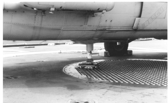
Figure 3 : Harpon verrouillé dans une grille d'appontage
