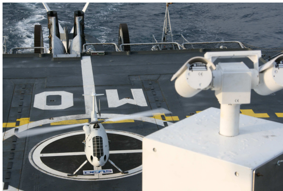
Figure 15 : Implantation de la caméra IR sur le toit du hangar hélicoptère
